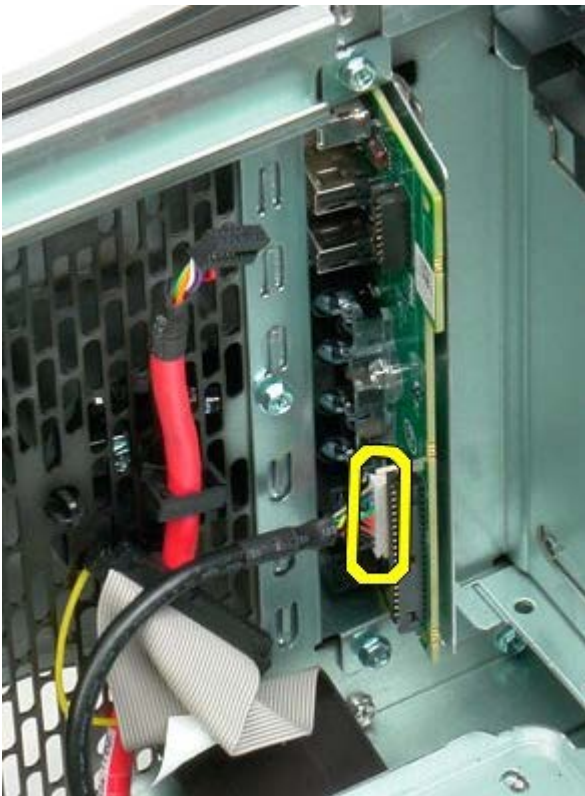
7. I/O 패널을 컴퓨터 케이스에 고정하는 나사를 분리합니다.
